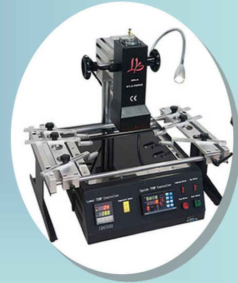
b) Estación de infrarrojos
